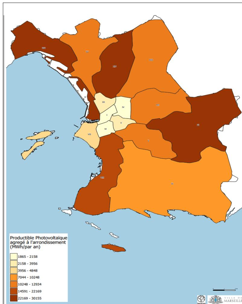
**Description :** Productible annuel total sur l'ensemble des pans de toiture du territoire sélectionné : ce productible dépend de l'orientation, de l'inclinaison de la localisation, et de la surface du pan de toiture sélectionné, ainsi que des ombrages projetés sur celui-ci. Il peut être filtré selon la rentabilité ou la puissance crête max du projet.
