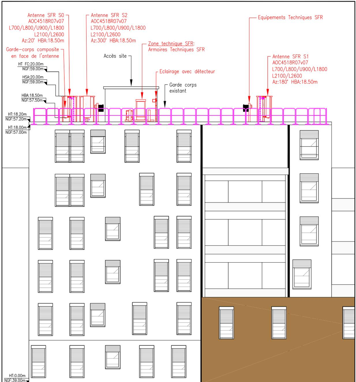
Les antennes sont installées dans des fausses cheminées de 1.00m x 1.30m x 2.00m
