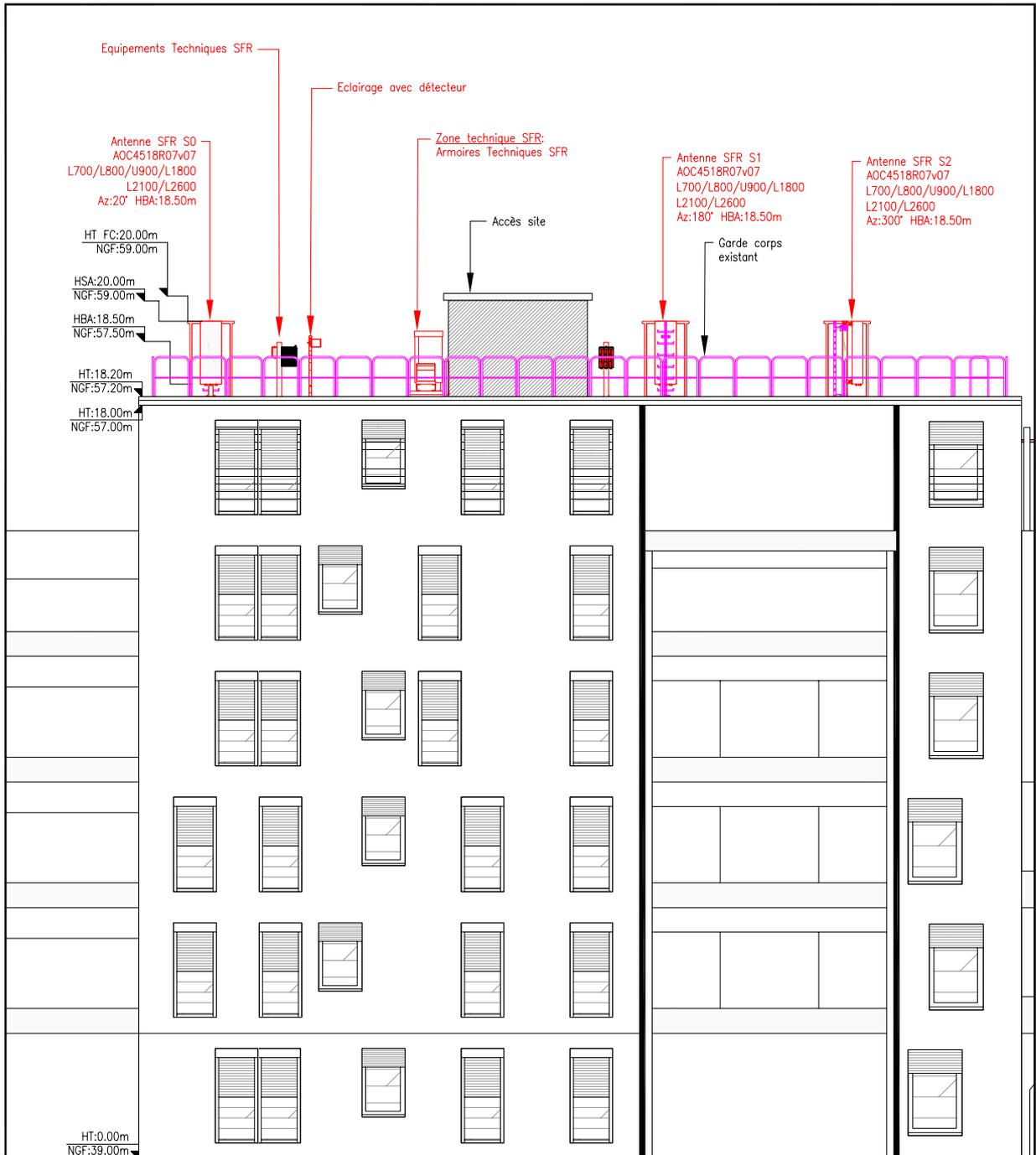
Les antennes sont installées dans des fausses cheminées de 1.00m x 1.30m x 2.00m
